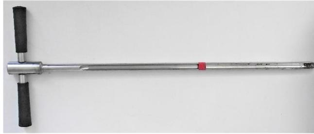
Abbildung 10: Pürckhauer, als Probenahmegerät für die Mikroplastikproben verwendet (mit roter Markierung für die Einstichtiefe).
