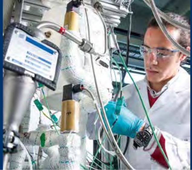
*Detailausschnitt einer Miniplant-Anlage am Fraunhofer ISE zur Herstellung von Methanol und Dimethylether (DME) unter Verwendung von Kohlendioxid und Wasserstoff.*
