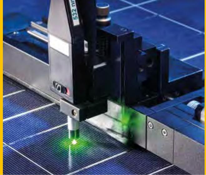
*Zerstörungsfreie Materialanalyse für PV-Module mittels Raman-Spektroskopie. Mit dieser Technologie wird das Degradationsverhalten des polymeren Verkapselungsmaterials von PV-Modulen orts aufgelöst bestimmt. Damit können Degradationsindikatoren für Lebensdauermodelle einfach gemessen und Alterungsmechanismen bestimmt werden.*
