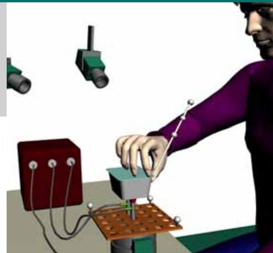
Messaufbau für die manuelle 3-D-Bewegungserfassung (Fraunhofer IPK)
