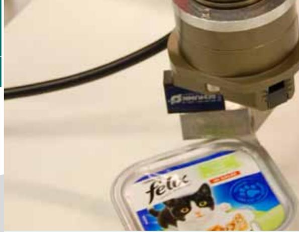
Automatisierte Verpackungsöffnung mit kraftgeregeltem Industrieroboter (Fraunhofer IPK)
