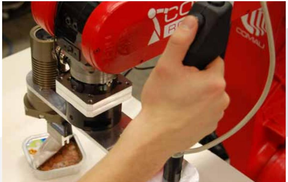
Prüfverfahren für Peel-Verschlüsse mit manueller Führung (Fraunhofer IPK)
