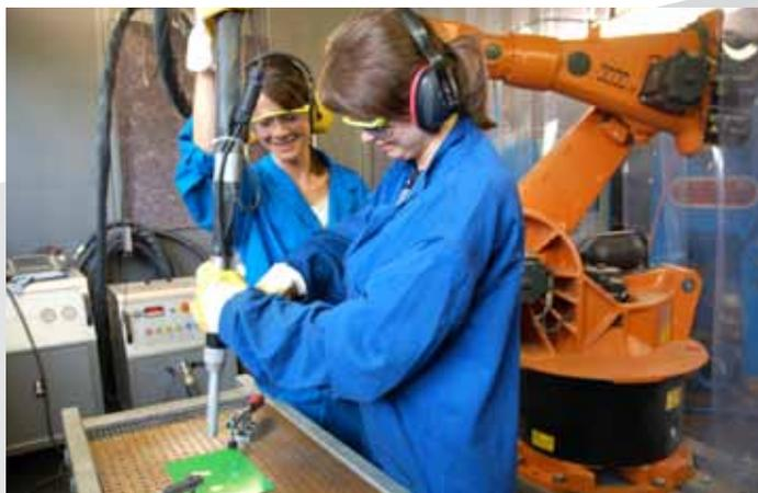
*Mit dem Trockeneisstrahler werden Bleche von Lack befreit*
