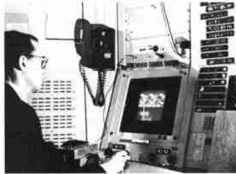
**Abbildung 3.1:** Benutzung des Sketchpad-Systems. Die Bedienung erfolgt mit Hilfe eines Lightpens und verschiedenen Knöpfen, Schaltern und Drehreglern. [Sutherland 1964]
