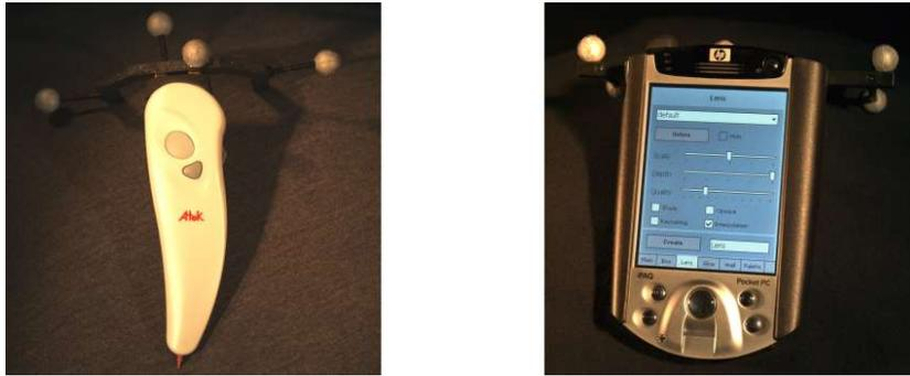
**Abbildung 2.3:** Optisch getrackte Eingabegeräte für Spatial Input Interaktion. (links) Ein drahtloses leicht modifiziertes Präsentations-Eingabegerät. Mit dem an der Unterseite befindlichen Stift kann ein stationärer oder zusätzlich gehaltener Tablet-PC bedient werden (rechts) Ein getrackter PDA erlaubt beispielsweise kontextbezogene 2D-Interaktion mit zuvor in 3D selektierten Objekten und die Darstellung privater Informationen in Mehrbenutzer-Szenarien.
