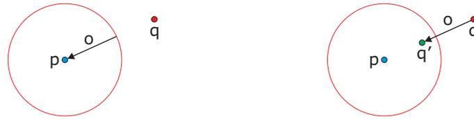
**Abbildung 4.4:** Beim Beenden des Snappings auf ein Ziel (hier ein punktförmiges Ziel  $\mathbf{p}$ ) mit der Snap-and-go-Technik entsteht bei Interaktion mit direkten Eingabegeräten ein Offset  $\mathbf{o}$ .  $\mathbf{q}$  bezeichnet hier die ursprüngliche Objektposition und  $\mathbf{q}'$  die Position nach Addition des Offsets. Die Snap-Range des Ziel-Objekts ist rot markiert.
