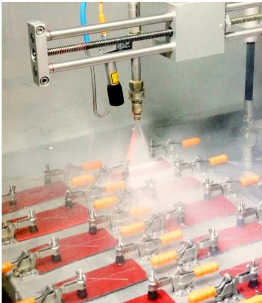
Abbildung 4: Dampfstrahltest zur Bestimmung der Lackhaftfestigkeit von Exterieur-Anbauteilen aus Kunststoff, Bildquelle: Fraunhofer IPA
