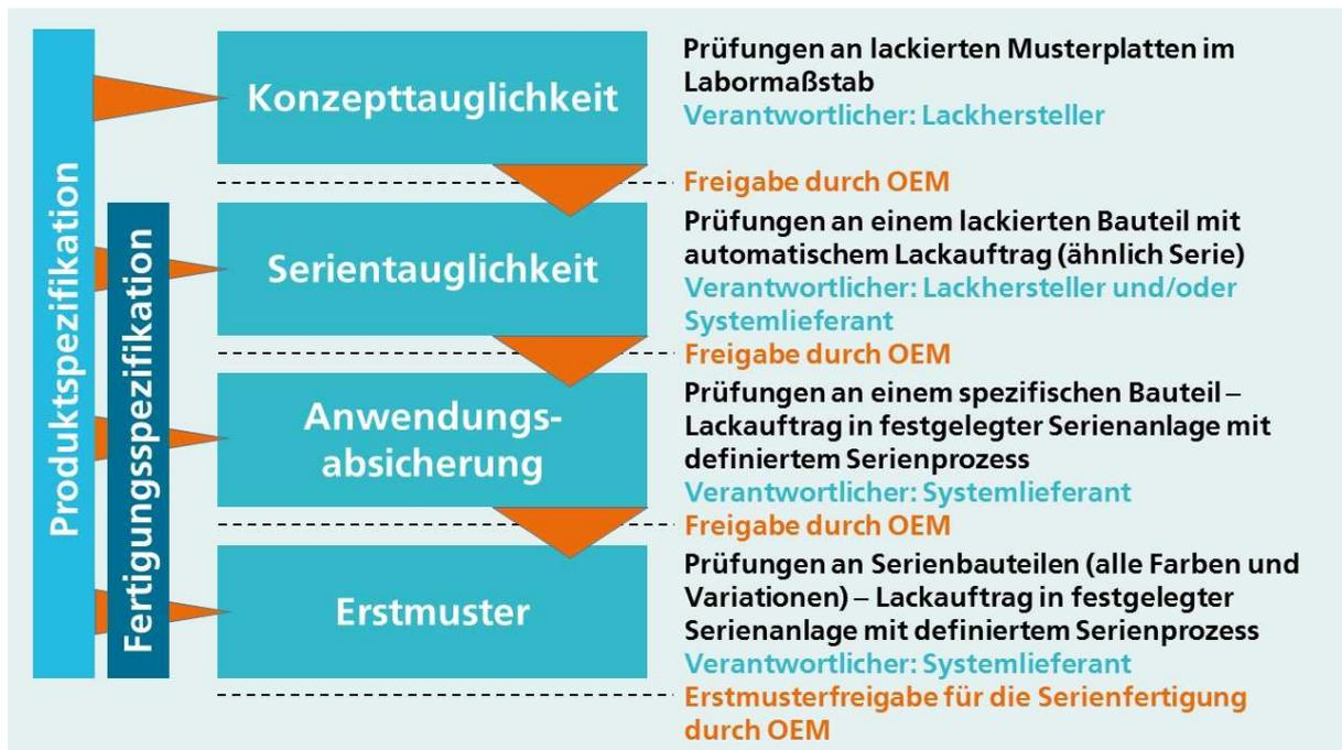
Abbildung 2: Übersicht des Freigabeprozesses für lackierte Kunststoffbauteile, Bildquelle: Fraunhofer IPA
