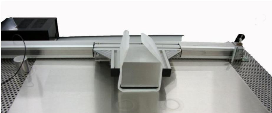
**Abbildung 2:** gleitende Fixierung des Reinraumtuches mittels Auflagegewicht
