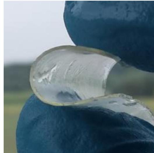
*Fotos der ausgehärteten Probe basierend auf UrDMA1 und UrMA1 (50/50) vor (links) und nach dem Eintauchen in Wasser (rechts).*
