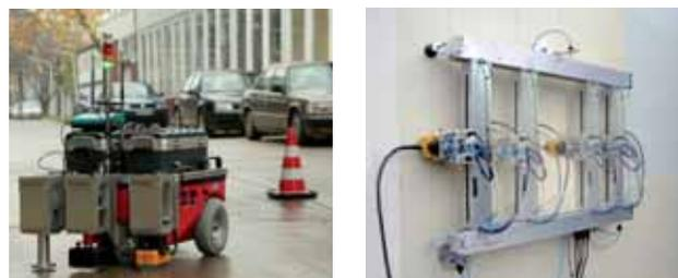
Abb. 1: Links BetoScan, selbstfahrender und autonom navigierender Multi-Sensor Roboter. Rechts OSSCAR, Multi-Sensor Bauwerksscanner.
