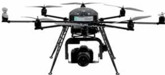
Abb. 2: Oktokopter mit Digitalkamera zur Gebäudeinspektion
