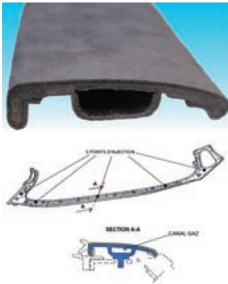
Schnitt durch Querverkleidung mit Gaskanal (Möller Group, Frankreich)
