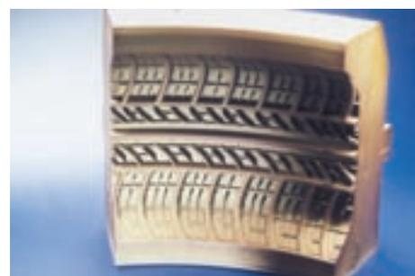
Bild 12: Mit SICON® beschichtete PKW-Reifenform für die Elastomerverarbeitung
