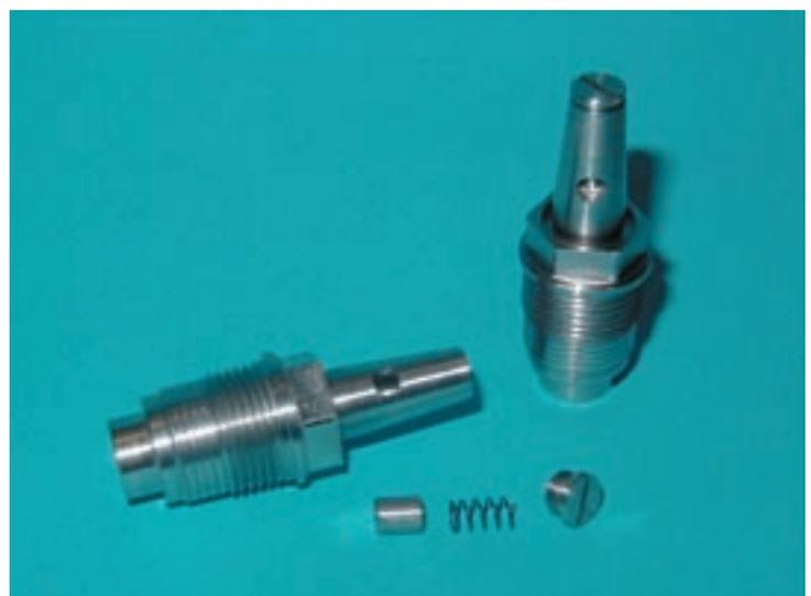
Bild 4: Federbetätigte WIT-Injektoren
