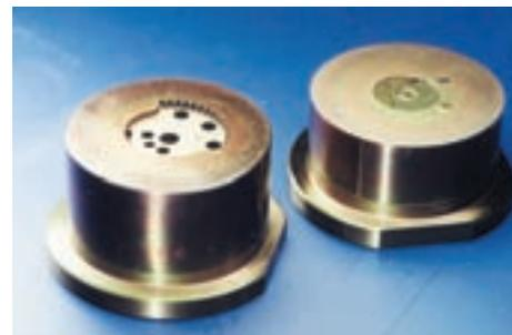
Bild 11: Mit SICON® beschichtete Spritzgusswerkzeuge zur Herstellung von feinmechanischen POM-Kunststoffteilen
