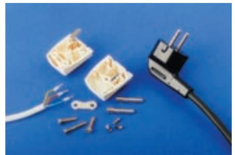
Bild 3: Stecker herkömmlich und durch Umspritzen hergestellt
