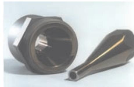
Bild 9: Ein mit SICON® beschichtetes Extrusionswerkzeug zur Herstellung von kunststoffummantelten Elektrokabeln
