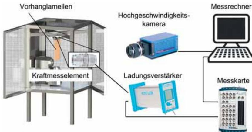
**Bild 5: Schematischer Versuchsaufbau und verwendete Messtechnik**
