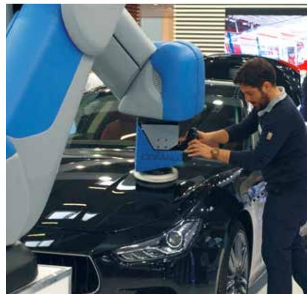
*Die neuen »Aura«-Roboter können Bearbeitungsaufgaben automatisch ausführen (oben). Durch die intuitive manuelle Führung des Roboters (unten) werden nur die Grenzen bzw. Ränder der zu polierenden Fläche vorgezeigt (Programmierung durch Vormachen). Die Anpresskräfte und Bewegungsmuster aber erzeugt der Roboter automatisch. (© Fraunhofer IPK/Jelena Radojicic mit freundlicher Genehmigung von Comau)*
