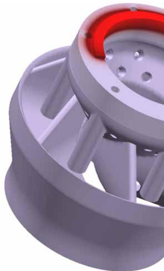
*Simulation des Materialauftrages auf einen Brenner*
