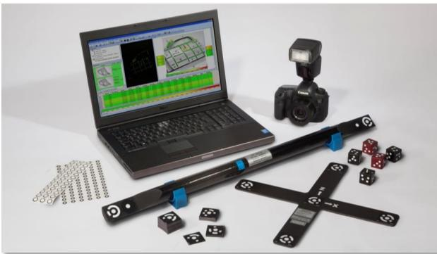
Bild 5.6: AICON *MoveInspect* DPA-System mit CFK-Maßstab und Koordinatenkreuz als photogrammetrisches Messsystem gemäß Bild 5.2a) (mit freundlicher Genehmigung der AICON GmbH)
