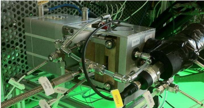
**Abb. 08: Testzelle von balticFuelCells GmbH angeschlossen am Teststand**
