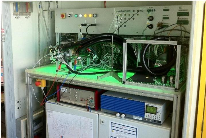
**Abb. 02: Neue Generation von Einzel-Testständen des Fraunhofer ISE mit installierter Testzelle und Dosiervorrichtung für zusätzliche Gase**
