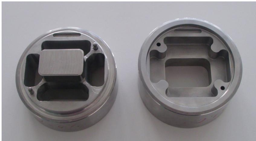
zweiteiliges Kammerwerkzeug zur
