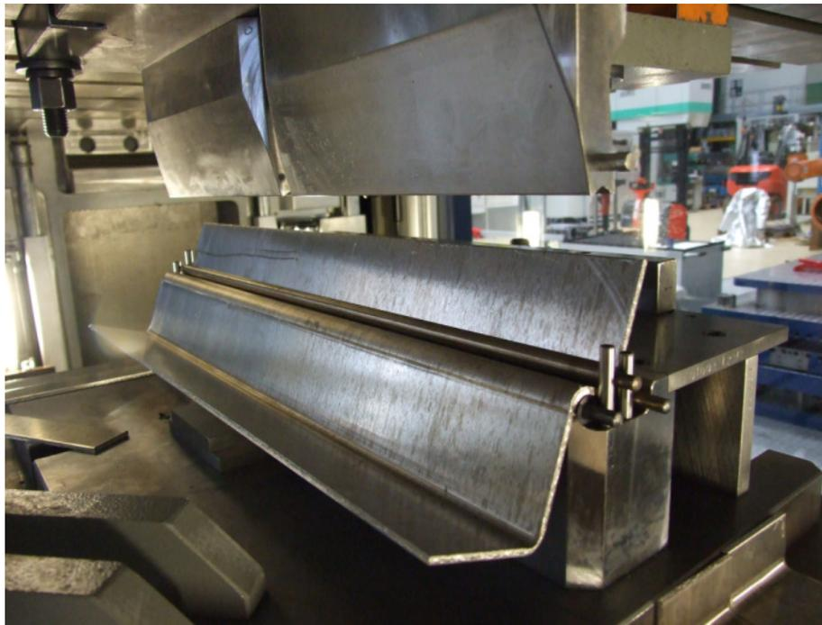
Versuchswerkzeug für Dreipunktbiegen mit eingelegtem Blech AZ31,  $s=3,0$  mm,  $r = 5$ mm
