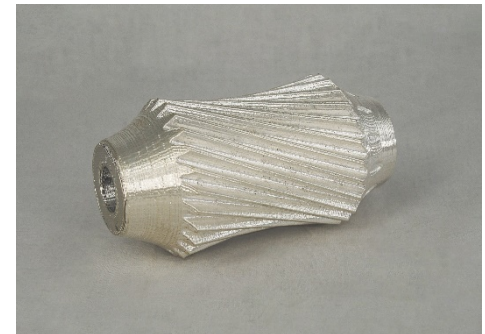
FDM-Part; metal coated via PVD Source : Fraunhofer IST 2017
