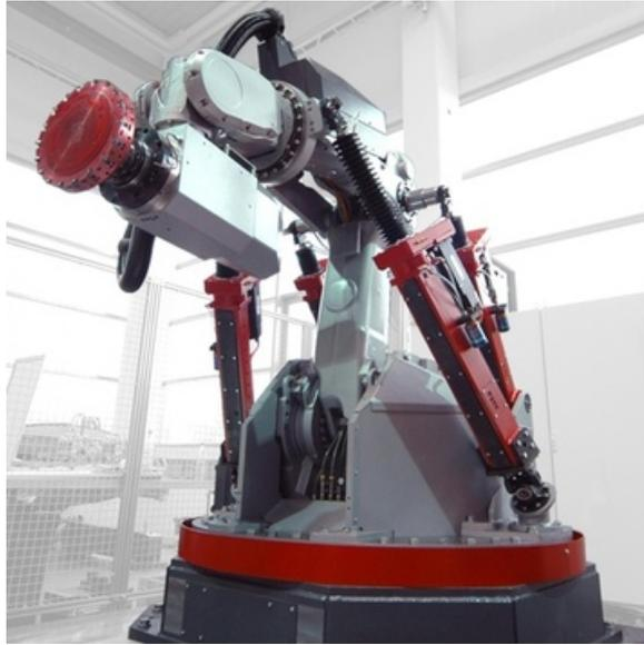
Abbildung 2.12: Durch parallele Streben verstärkter Industrieroboter mit erhöhter Steifigkeit zum Zerspanen (Fill 2014)
