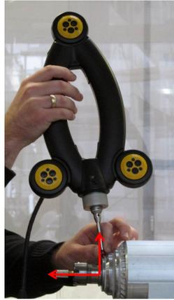
Abbildung 4.18: Definition der Koordinatensysteme mit der Space-Probe des K600
