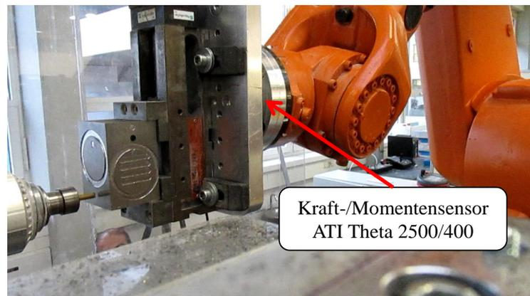
Abbildung 5.7: Validierung der Abdrängungskompensation am Beispiel des Fräsens einer Kreisgeometrie
