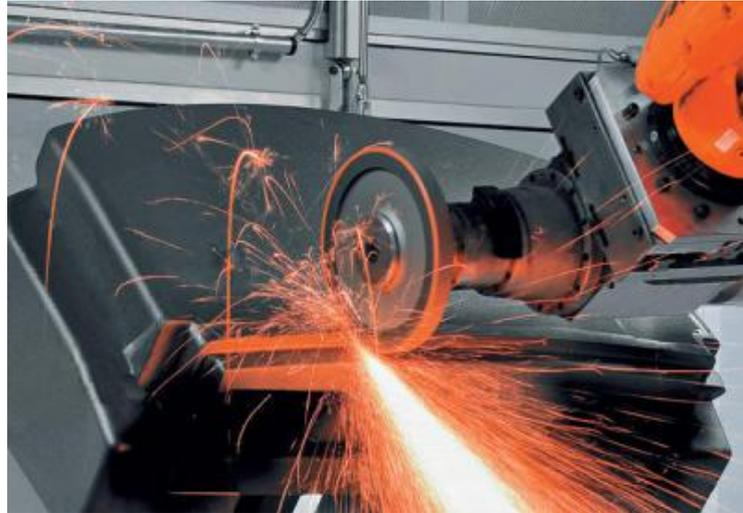
Abbildung 2.2: Kraftgeregeltes Schleifen mit IR (ABB Robotics 2014)
