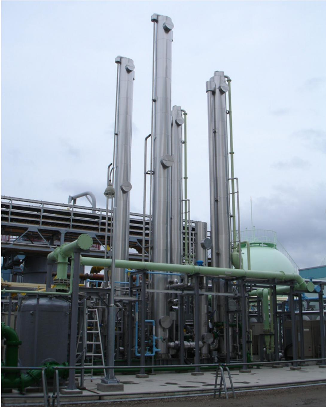
Abbildung 4-4: Flotech-Druckwasserwäsche CSFR-225 in Kobe, Japan (Quelle: Flotech)
