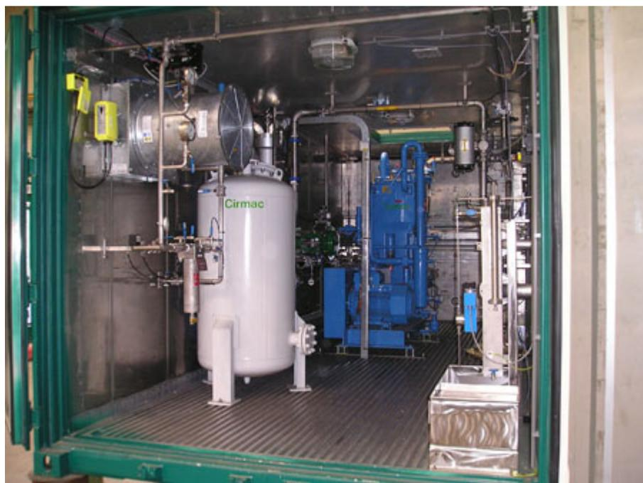
Abbildung 4-12: Membrantrennanlage zur Biogasaufbereitung der Fa. Cirmac (Quelle Fa. Cirmac)
