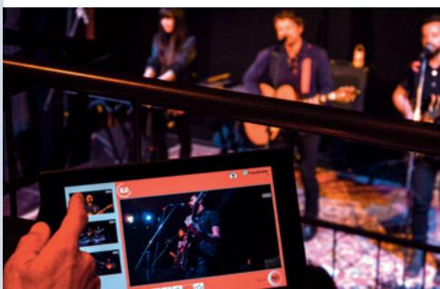
Das Multikamera-Videosystem »HIGGS« des Fraunhofer IIS ermöglicht Videoproduktionen in Echtzeit und umfasst bis zu fünf mobile Kameras sowie eine App für einen flexiblen Schnitt.
