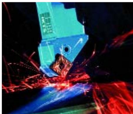
Keramische Schneidwerkzeuge im Drehtest
