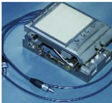
SH-Senderwandler mit Keramikverschleißplatte und Aufhängung
