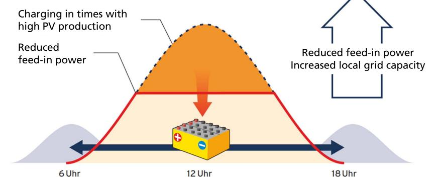
Source: J. Mayer (BSW), C. Wittwer (ISE), Batteriespeicher: Ein sinnvolles Element der Energiewende. Berlin, Pressefrühstück 25.1.2013
