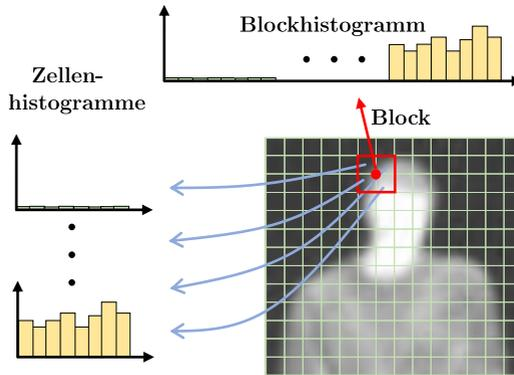
**Abbildung 5.4:** Berechnung eines Blockdiagramms: Die Zellenhistogramme innerhalb eines Blocks werden durch Konkatentation zu einem Blockdiagramm zusammengefasst.
