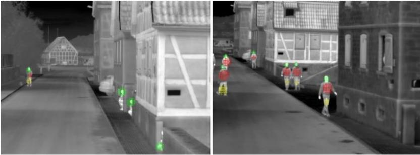
**Abbildung 5.10:** Beispielergebnisse der MaL basierten Körperteildetektion: Kopf- (grün), Torso- (rot) und Bein-Detektionen (gelb).
