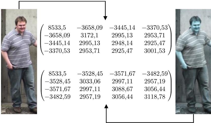
**Abbildung 3.7:** Kovarianzdeskriptoren für zwei Bildausschnitte, die bis auf einen unterschiedlichen Farbton identisch sind. Die Kovarianzdeskriptoren wurden wieder aus  $y$ -Koordinaten und Farbwerten (RGB-Farbraum) berechnet und die Reihenfolge entspricht Abbildung 3.6. Der Farbtonunterschied erzeugt einen Abstand von 0,39, der zwar höher als bei dem Beispiel mit dem künstlichen Rauschen in Abbildung 3.6 ist, aus praktischer Sicht jedoch nach wie vor als klein angesehen werden kann.
