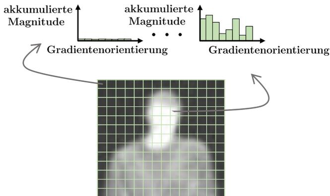
**Abbildung 5.3:** Berechnung der Zellenhistogramme: Ein skaliertes Bildausschnitt wird in gleich große Zellen geteilt und für jede Zelle ein Zellenhistogramm aus den Gradientenrichtungen und -magnituden berechnet.
