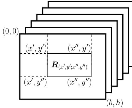
**Abbildung 3.5:** Veranschaulichung des 3D-Arrays  $F[\cdot, \cdot, \cdot]$  (Array von Merkmalsvektoren  $\mathbf{f}_{(x,y)}$ ) und Definition des Rechtecks  $\mathbf{R}$ . Die einzelnen dargestellten Ebenen entsprechen  $F[\cdot, \cdot, a]$ ,  $a = 0, \dots, e - 1$ . Das Rechteck  $\mathbf{R}$  ist durch  $\mathbf{R}_{(x', y'; x'', y'')} = \{(x, y) \mid x' \leq x < x'', y' \leq y < y''\}$  definiert.
