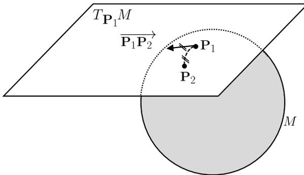
**Abbildung 4.1:** Die 2-Sphäre  $\mathbf{S}^2$  ist ein Beispiel für eine 2-dimensionale differenzierbare Mannigfaltigkeit. Sie ist lokal – in einer kleinen Umgebung um jeden Punkt  $\mathbf{P} \in M$  der Mannigfaltigkeit – diffeomorph zu einer Tangentialebene  $T_{\mathbf{P}}M$ ,  $\mathbf{P} \in M$ , in der geometrische Berechnungen durchgeführt werden können, da die Mannigfaltigkeit mit einer riemannschen Metrik versehen werden kann.
