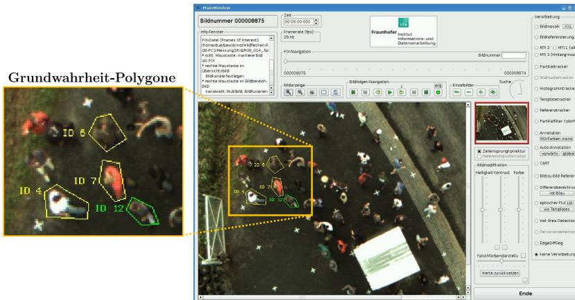
**Abbildung 6.8:** Bildschirmfoto des eingesetzten Annotationswerkzeugs mit einem vergrößerten Bildausschnitt, der beispielhaft vier annotierte Grundwahrheit-Polygone zeigt. In jedem Bild wurden alle Personen durch ein Polygon mit mindestens vier Ecken umrandet. Die Farben der Polygone sind im Rahmen dieser Evaluation irrelevant. Das grüne Polygon beispielsweise steht für das aktuell ausgewählte bzw. das zuletzt gezeichnete Polygon.
