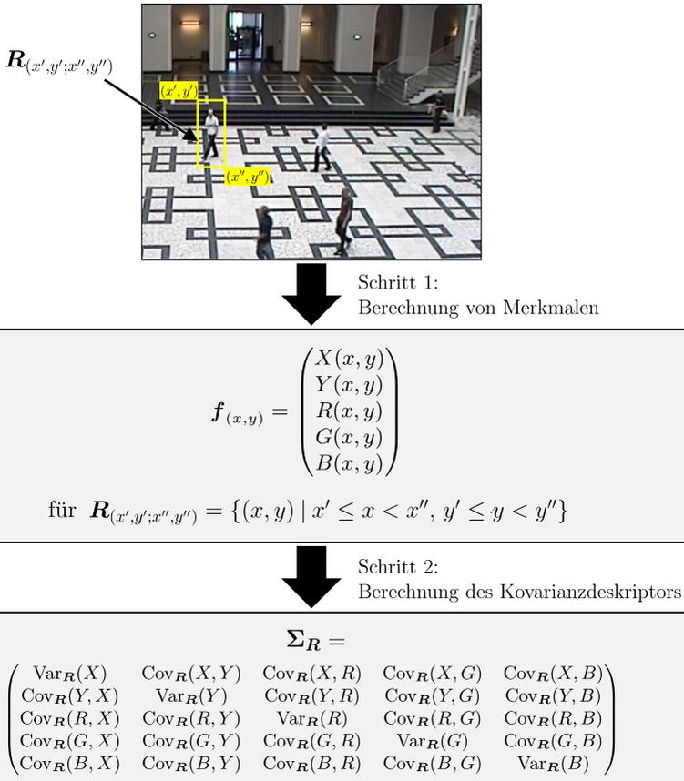
**Abbildung 3.1:** Konzept für die Berechnung von Kovarianzdeskriptoren. Im ersten Schritt wird für jedes Pixel innerhalb der Bildregion, die durch  $\mathbf{R}_{(x',y';x'',y'')} = \{(x,y) \mid x' \leq x < x'', y' \leq y < y''\}$  definiert ist, ein Merkmalsvektor  $\mathbf{f}_{(x,y)}$  extrahiert.  $\text{Var}_{\mathbf{R}}$  und  $\text{Cov}_{\mathbf{R}}$  sind die Varianzen der einzelnen Merkmale bzw. Kovarianzen zwischen den Merkmalen für die Bildregion  $\mathbf{R}$ .
