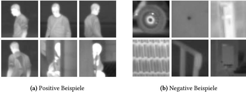
**Abbildung 5.5:** Beispiele von Bildausschnitten, die für das Training der HOG-basierten Körperteildetektion verwendet wurden. Als positive Beispiele wurden Körperteilpartien verwendet, von denen einige teilweise verdeckt sind (a). Die negativen Beispiele wurden zufällig aus dem MOUT-Datensatz extrahiert (b).
