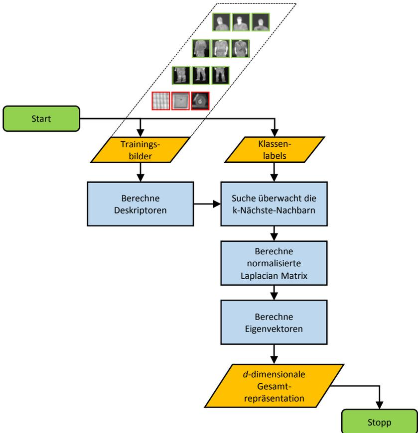
**Abbildung 5.8:** Übersichtsdiagramm über die Trainingsphase: Das Lernen der  $d$ -dimensionalen Gesamtrepräsentation des Trainingsdatensatzes. Mittels dem Ähnlichkeitsmaß, das durch die Gleichung (5.5) definiert ist, wird eine  $d$ -dimensionale Gesamtrepräsentation aller Untermannigfaltigkeiten überwacht gelernt.
