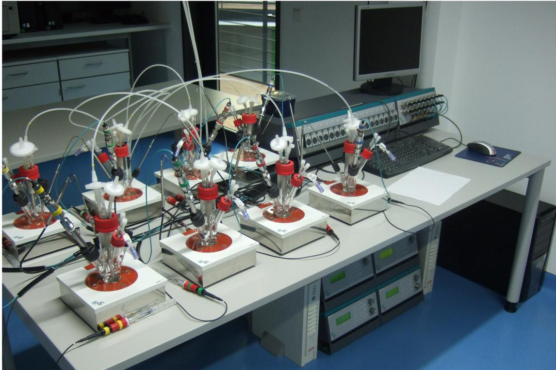
**Abbildung 3.1:** Aufbau der 8 parallelen Mini-Suspensionsbioreaktor Einheiten.
