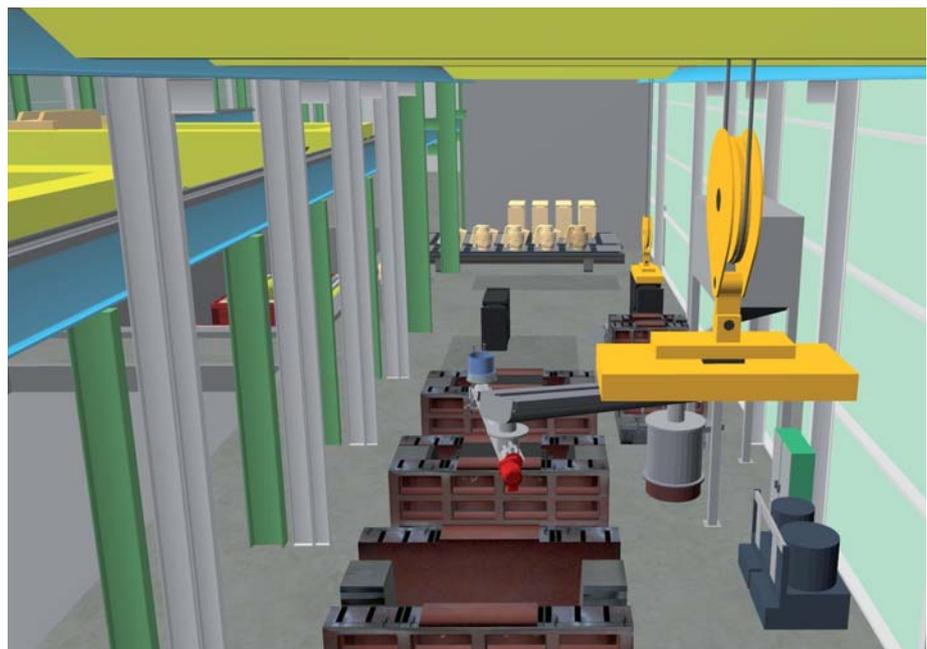
Bild 1: 3-D-Modell zur Visualisierung der Platzverhältnisse in der Kernmacherei.
