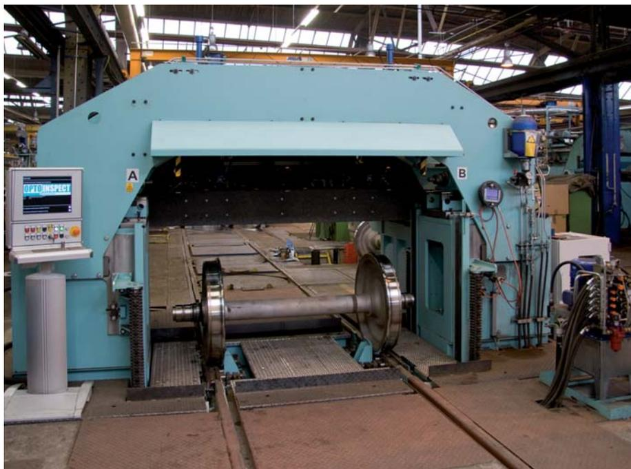
Bild 1: Radsatzmessstand. Foto: DB Fahrzeuginstandhaltung GmbH, Werk Paderborn
