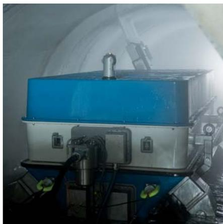
Bild 1: Prototyp Inspektionssystem im Magdeburger Versuchsstand. Foto: Bernd Liebl
