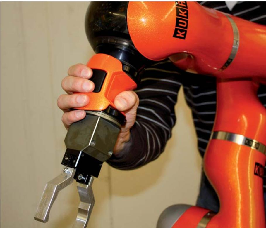
Bild 2: Der neuentwickelte Handführgriff im Einsatz.
