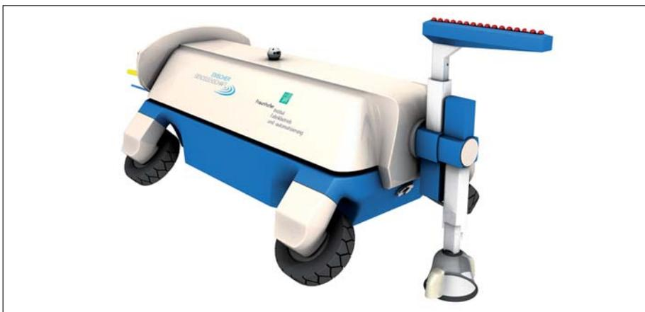
Bild 3: Reinigendes Inspektionssystem – Entwurf der Nullserie.
