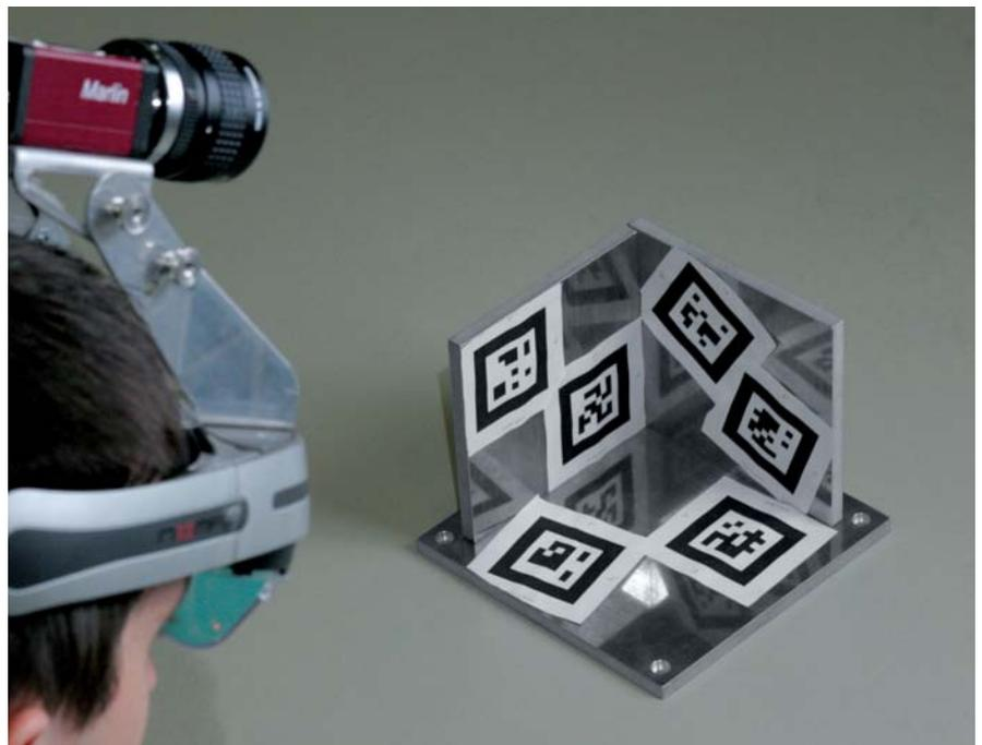
Versuchsanordnung zur Optimierung der See-Through-Kalibrierung für mobile Augmented Reality-Assistenzsysteme. Foto: Jens Grubert
