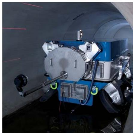
Bild 2: Prototyp Reinigungssystem im Magdeburger Versuchsstand. Foto: Bernd Liebl
