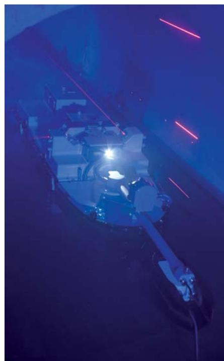
Bild 1: Schadenerkennungssystem (SEK) zur Vorinspektion von großen Abwasserkanälen.
