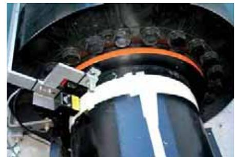
Bild 1: Realisierung der Drehmoment-, Drehzahl- und Drehwinkelmessung an der Hauptwelle einer Windenergieanlage.
