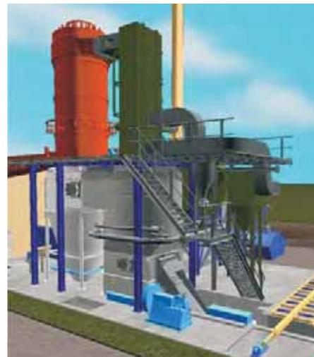
Bild 3: 3-D-Darstellung der Feuerungsanlage (grau) mit Thermoölkessel (rot) und Economisern (grün).
