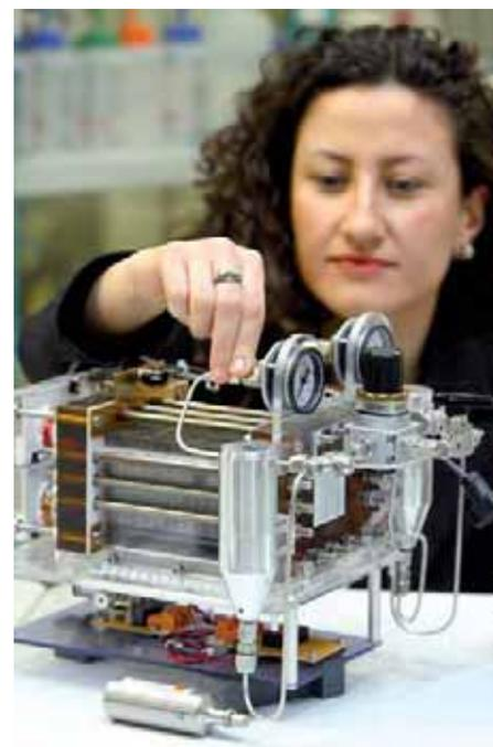
Bild 2: Demonstrator eines Niedertemperatur-Brennstoffzellenstacks (PEMFC).
