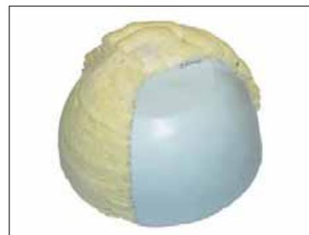
Bild 3: Kombination von schichtweisem Modellaufbau mit anschließender Fräsbearbeitung. Foto: Torsten Felsch
