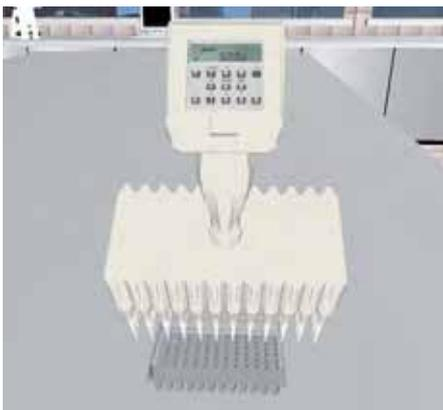
Bild 2: Die virtuelle Metapher »96er-Pipette« vereinfacht die Programmierung von Laborabläufen.
