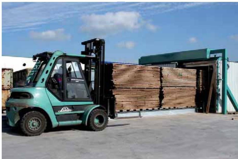
Bild 1: Beschickung der Hochtemperatur-Trockenkammer. Foto: Torsten Böhme
