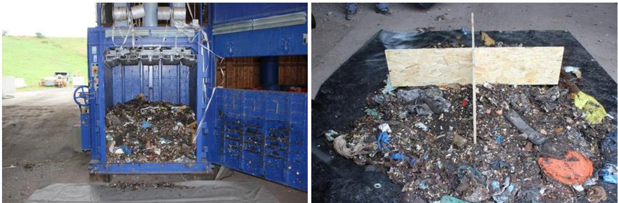
**Abbildung 5.** Portalpresse (Typ: PP 1207) der Fa. Strautmann Umwelttechnik (links) und Probenentteilung mittels Probenkreuz (rechts).
