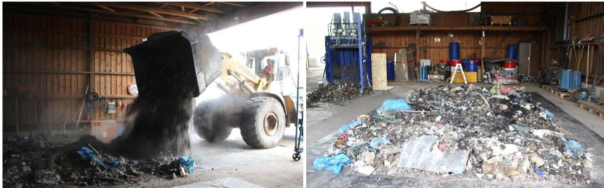
**Abbildung 2.** Ausbreiten des Müllbetts mittels Radlader (links) sowie das entstandene Müllbett (rechts).
