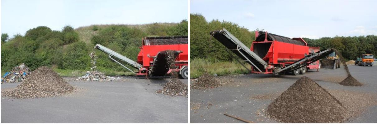
**Abbildung 6.** Großtechnische Siebung des frischen Hausmülls mit einem 40 mm Sieb (links) sowie großtechnische Siebung des frischen Hausmülls mit einem 10 mm Sieb (rechts).
