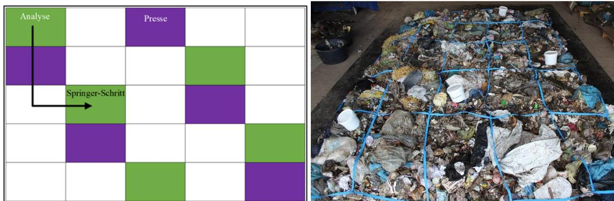
**Abbildung 3.** Schematisches Vorgehen der Probenahme (links) und ausgebreitetes Müllbett mit Raster sowie den Eimern für die 4 Einzelproben (rechts).
