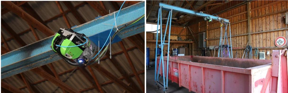
**Abbildung 7.** 3D-Laserscanner (Produkt L3000D-118) der Firma LASE Industrielle Lasertechnik GmbH (links) und Prüfstand mit montiertem Laser in der Fahrzeughalle des Abfallwirtschaftszentrums Rothmühle in Bergheinfeld (rechts).
