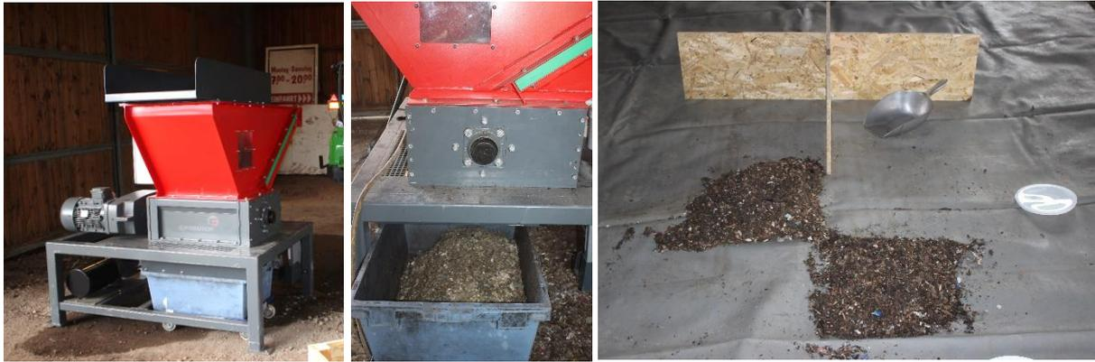
**Abbildung 4.** Einwellen-Zerkleinerer (Typ: M600/1-600-5,5 kW) der Fa. Erdwisch (links), Einwellen-Zerkleinerer mit zerkleinertem Müll (Mitte), Verjüngung des zerkleinerten Mülls mittels Probenkreuz (rechts).
