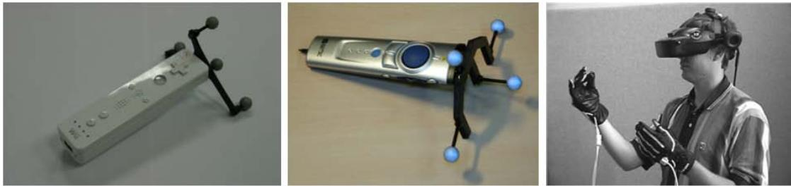
Abbildung 2.2.: (v.l.n.r.) Wii Remote mit A.R.T.-Target, Kabelloser Stylus mit A.R.T.-Target, Benutzer mit Datenhandschuhe und HMD-Display (entnommen aus [Bowman u. Wingrave, 2001])
