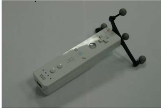
Abbildung 3.3.: Eine präparierte Wii Remote für den Einsatz im VRGeo Demonstrator. Am vorderen Ende sind die retroflektiven Marken zu sehen, die von den Infrarotkameras getrackt werden.
