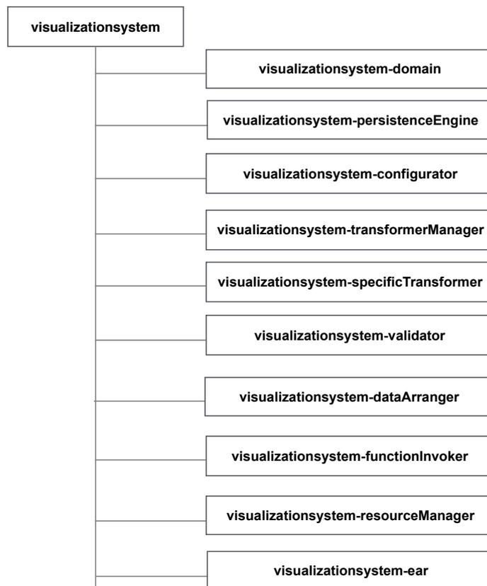
Abbildung 17: Modulstruktur des Projekts visualizationsystem in Maven
