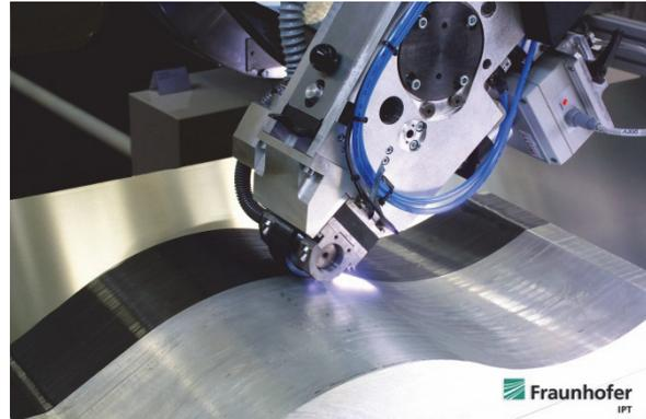
**Abbildung 8:** Tapeablegeeinheit des Fraunhofer IPT [173]
