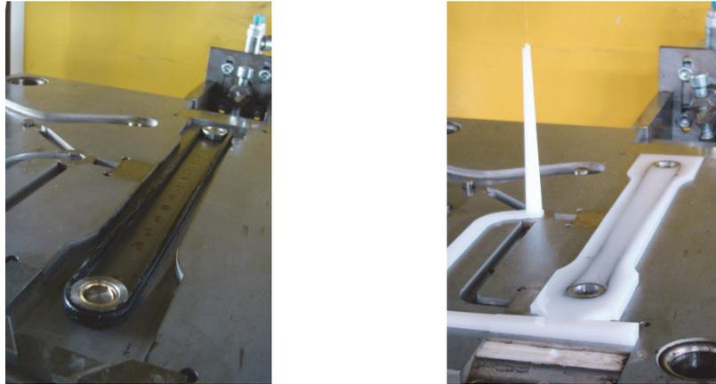
**Abbildung 80:** Zugprüfkörper einer umspritzten Faserverbundschlaufe
