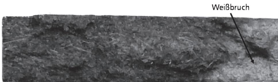
**Abbildung 53:** Bruchfläche einer PP/LGF-Probe bei Raumtemperatur [159]
