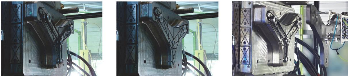
**Abbildung 88:** Verfahrensablauf beim Umspritzen der gewickelten Verstärkungsstruktur
