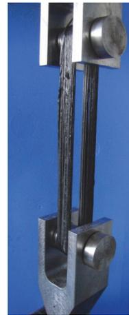
**Abbildung 45:** Zugprüfmaschine Inspekt table 50 (links) und Einspannvorrichtung für Faserverbundschlaufen (rechts)
