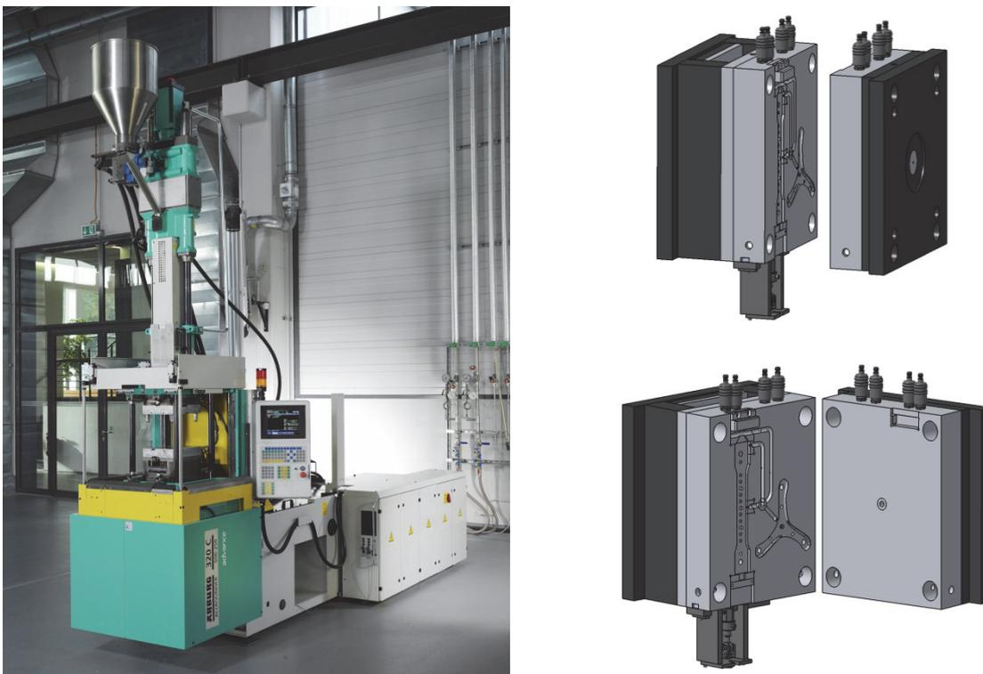
**Abbildung 26:** Spritzgießanlage Allrounder 320 C / 600-250 U (links) und Spritzgießwerkzeug zur Herstellung generischer Prüfkörper (rechts)
