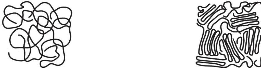
**Abbildung 10:** Geknäuelte Kettenmoleküle (links) und teilkristalline Struktur (rechts) [34]
