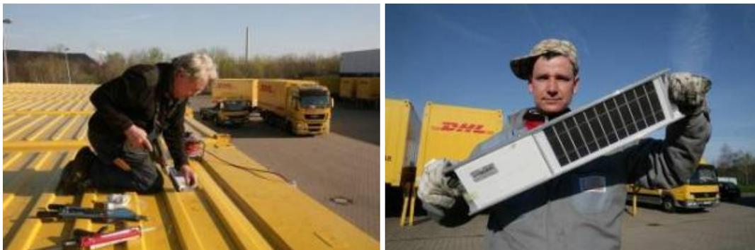
Abbildung 32: Ausstattung der Wechselbrücken mit Echtzeit-Ortungssystemen (Quelle: Deutsche Post)
