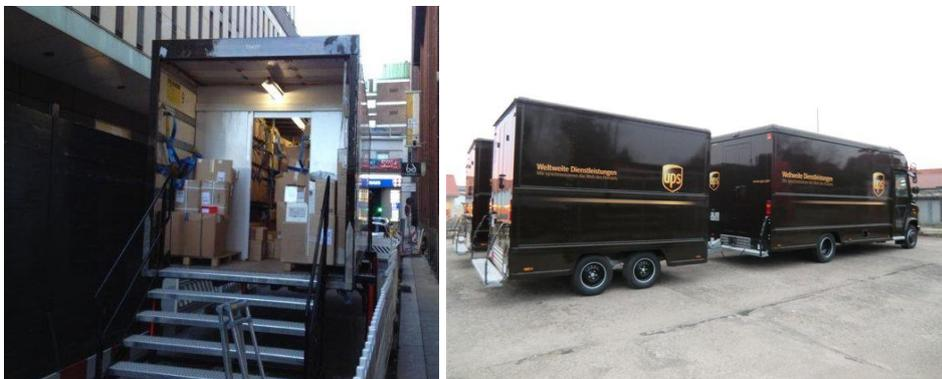
Abbildung 23: Mobile Depots - Umgebauter Container mit Regalsystem Abgrenzung (links) und Zustellfahrzeuge mit Paketwagenanhänger (rechts) (Quelle: UPS)
