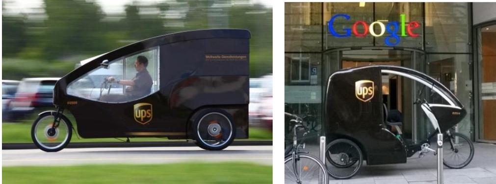
Abbildung 21: E-unterstütztes Lastenfahrrad »Cargo Cruiser« (links) und »Cyclo Cargo« (rechts) (Quelle: UPS)
