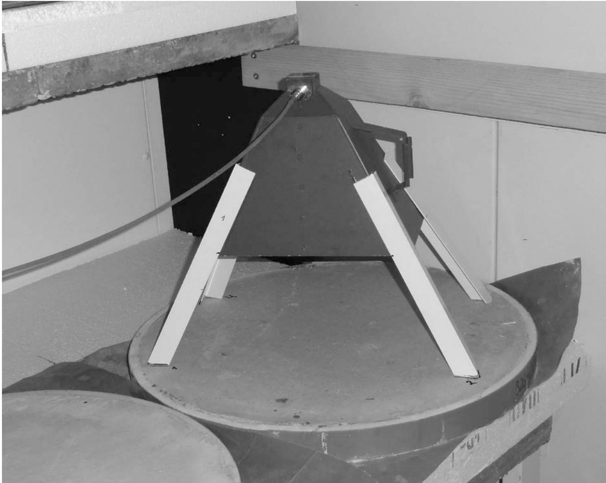
**Fig. 1:** Auf die Estrichprobe aufgesetzte Breitbandantenne (Antenne 2)
