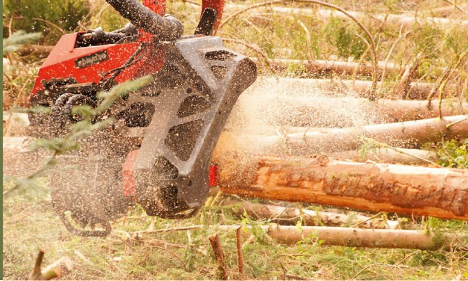
Baumfällarbeiten mithilfe mechanisierter Erntemaschinen.
