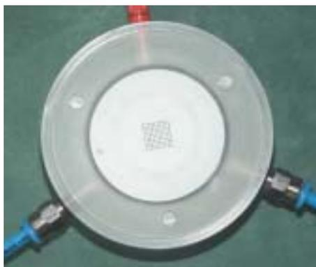
Bild 1: Versuchsaufbau für Plasma Printing.
