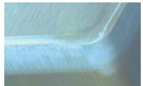
Bild 5: Schichtverschleiß nach Entfernung der Ablagerungen: braune Deckschicht SiCON® (a-C:H:Si:O) verschlissen, Stützsicht CrN erhalten.
