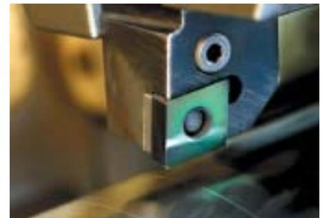
Bild 2: cBN-Schicht auf einer Hartmetall-Wendeschneidplatte.
