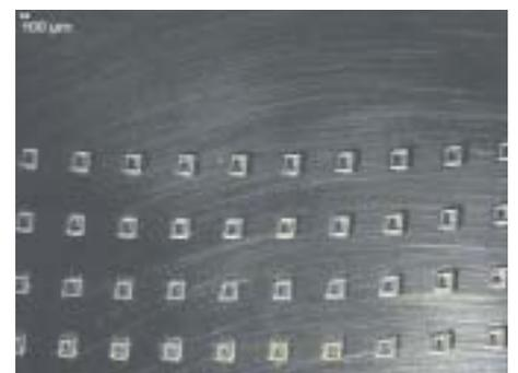
Bild 6: Homogene Strukturen auf einem Kugelenkel, die als Schmierfilmreservoir dienen.
