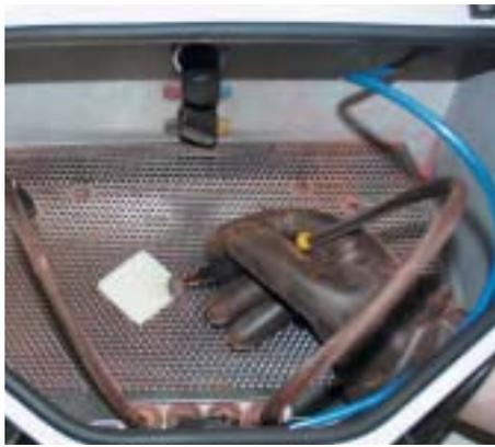
Bild 1: Laboranlage zum Kugelstrahlen.
