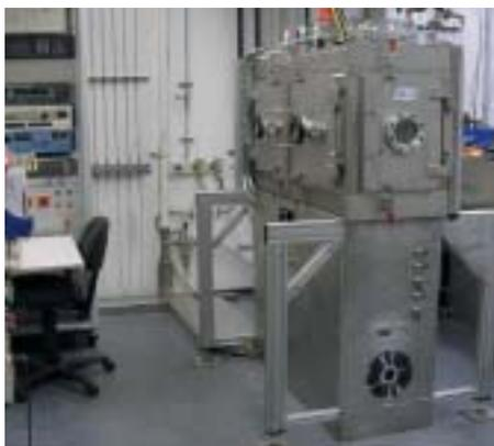
Bild 1: MHC-Reaktor, Außenansicht.
