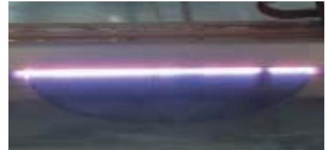
Bild 4: Vorbehandlung eines Silizium-Wafers vor dem Silizium-Direkt-Bonden mittels DBD-Behandlung.
