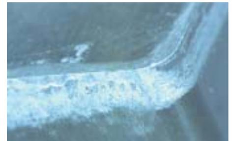
Bild 3: Starke Ablagerungen auf einem unbeschichteten Schneidstempel aus Werkzeugstahl.
