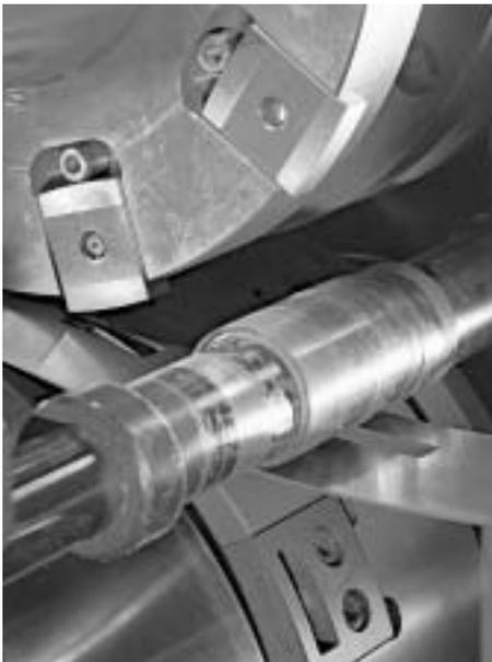
Bild 1: Rotationschneidmaschine mit Stempel (oben) und Matrize (unten). [Quelle: utg, TU München]
