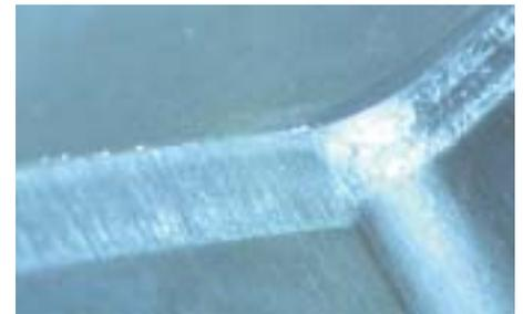
Bild 4: Geringe Ablagerungen auf einem beschichteten Schneidstempel, Schichtsystem: CrN + C-DLC (a-C:H gesputtert).
