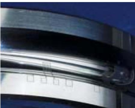
Bild 3: Sensorstruktur in der Lauffläche eines Radiallagers.
