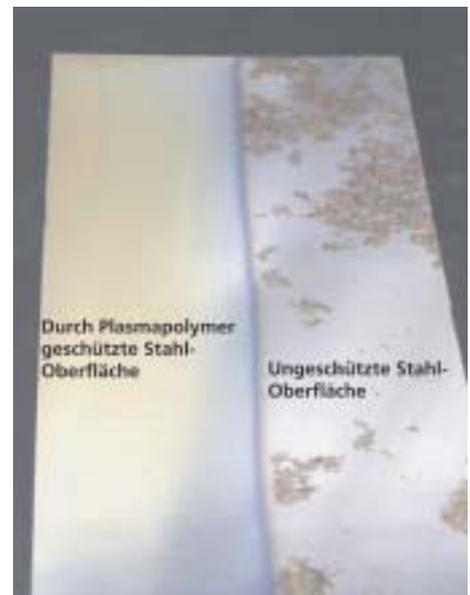
Bild 2: Mit dem SHC-Verfahren hergestellte dünne Plasmapolymerschicht (linke Seite) als wirksamer Korrosionsschutz auf Stahlblech.
