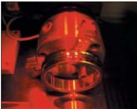
Bild 2: Laserstrukturierung eines Radialagerringes mit Nd:YAG-Festkörperlaser unter Verwendung einer Rotationseinheit.
