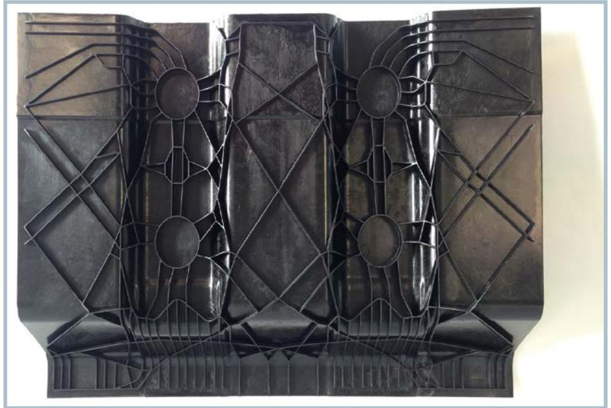
**Bild 4.** Unterbodensegment der Prozessroute 2 mit fließpressgeformten Versteifungsrippen
