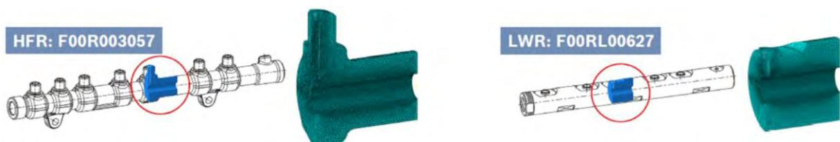
**Abb. 4-3:** Darstellung der Schnittebenen für die Simulation der Eigenspannungen autofrettierter Common-Rails (links: HFR, rechts: LWR (Quelle: [BoschIntern2011]))
