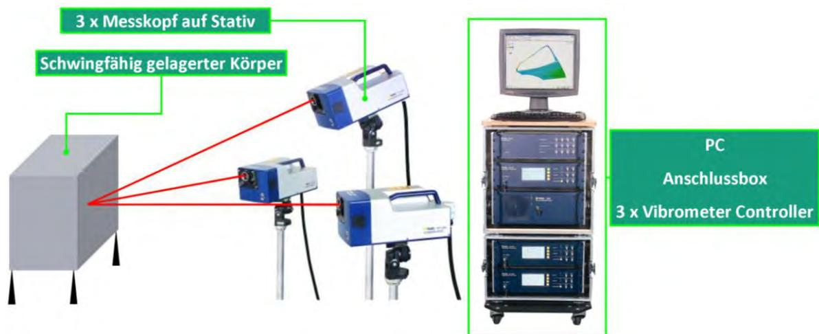
**Abb. 4-19:** Bearbeitete fotografische Aufnahme des Laservibrometers des IZPF (in Anlehnung an [Polytechnern2011])
