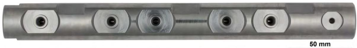
**Abb. 4-2:** Fotografische Aufnahme eines lasergeschweißten Common-Rails (LWR)
