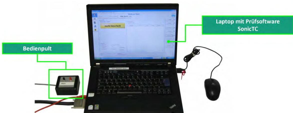
**Abb. 4-18:** Bearbeitete fotografische Aufnahme des Prüflaptops sowie des Bedienpults zur Impulsauslösung
