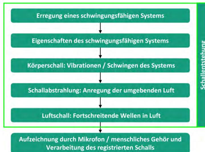
**Abb. 2-9:** Darstellung der Entstehung von Luftschall (in Anlehnung an [Gerusel1998, S. 19])
