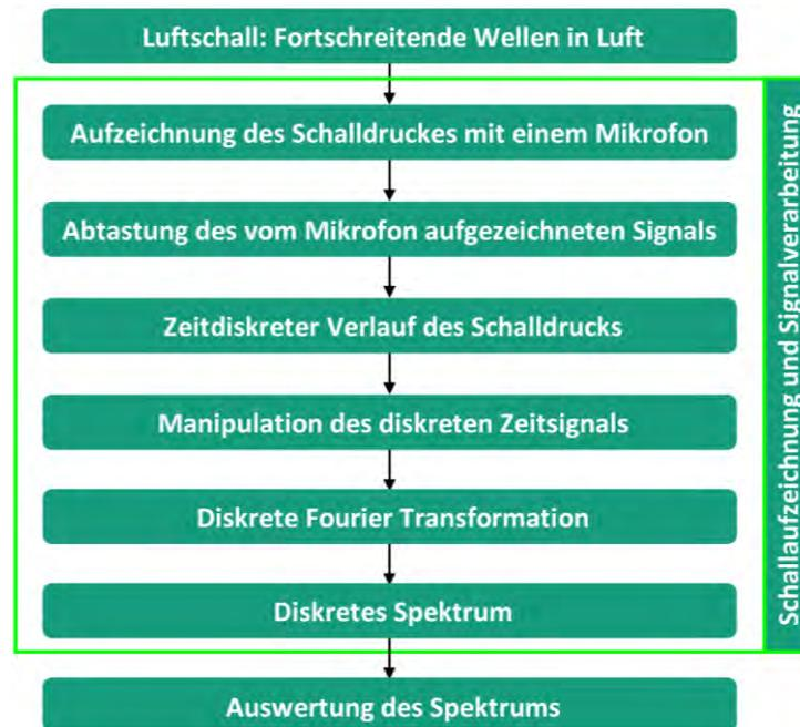
**Abb. 2-18:** Darstellung der messtechnischen Erfassung von Luftschall und der Weiterverarbeitung des aufgezeichneten Signals
