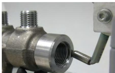
**Abb. A-7:** Fotografische Aufnahme von Alternativaufbau 3: Axiale Bauteilanregung – Position und Orientierung der Impulsanregung
