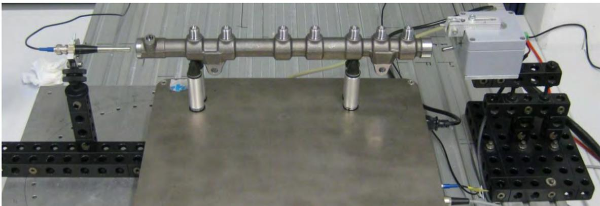
**Abb. A-6:** Fotografische Aufnahme von Alternativaufbau 3: Axiale Bauteilanregung
