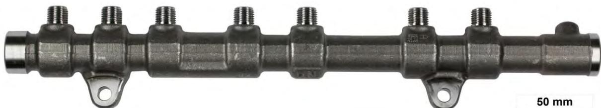
**Abb. 4-1:** Fotografische Aufnahme eines geschmiedeten Common-Rails (HFR)
