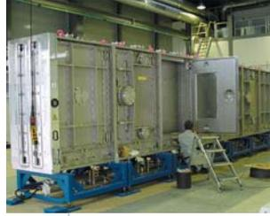
Mit der Anlieferung und dem Aufbau der Kammermodule durch die Fa. Leybold Optics Dresden begannen die Installationsarbeiten der In-line-Sputteranlage ILA 900.
