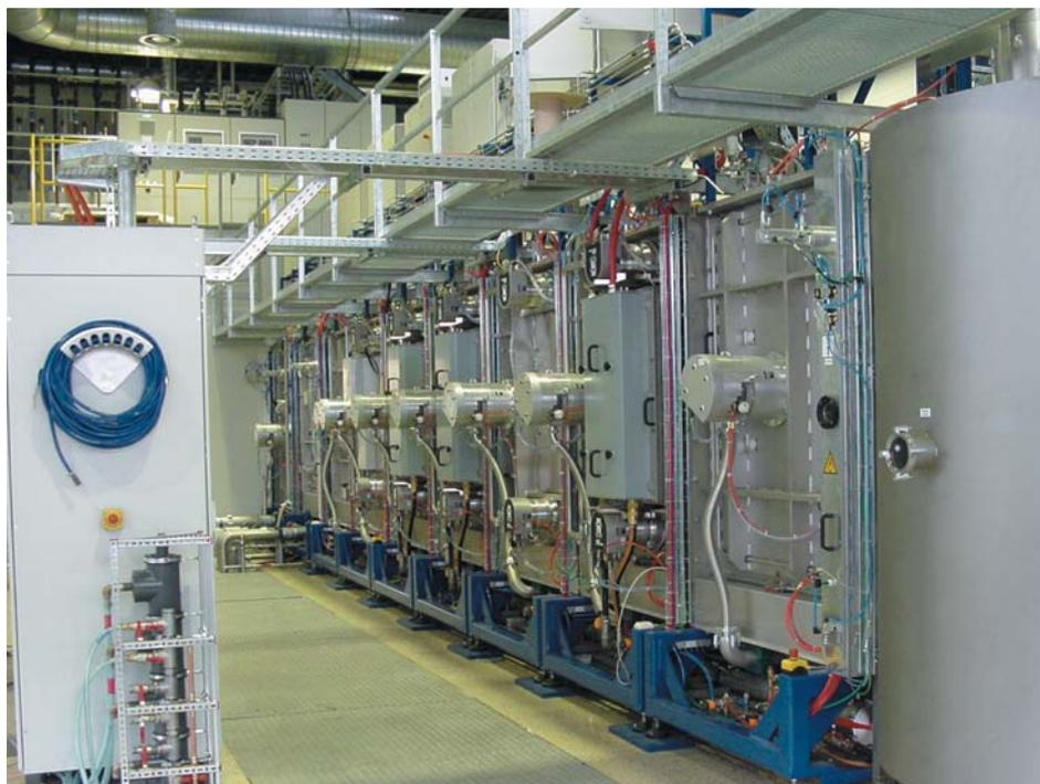
Die Anlage ermöglicht sowohl die einseitige Beschichtung von Substraten mit bis zu 10 Einzelschichten als auch eine Zweiseitenbeschichtung mit dann maximal 5 Einzelschichten pro Seite. Als Technologien zur Substratvorbehandlung wurden inverse HF-Sputter-
