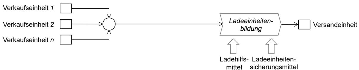
Abbildung 15: Varianten für Prozessabläufe der Packstückbildung und Ladeeinheitenbildung<sup>284</sup>
