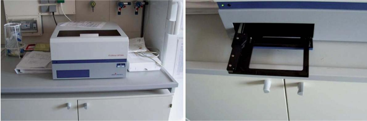
Abbildung 5: Fluoreszenz-Reader FLUOstar OPTIMA (links) und geöffneter Probeneinzug (rechts)
