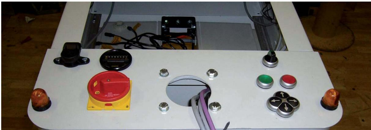
**Abbildung 11: Bedienelemente der Plattform**
