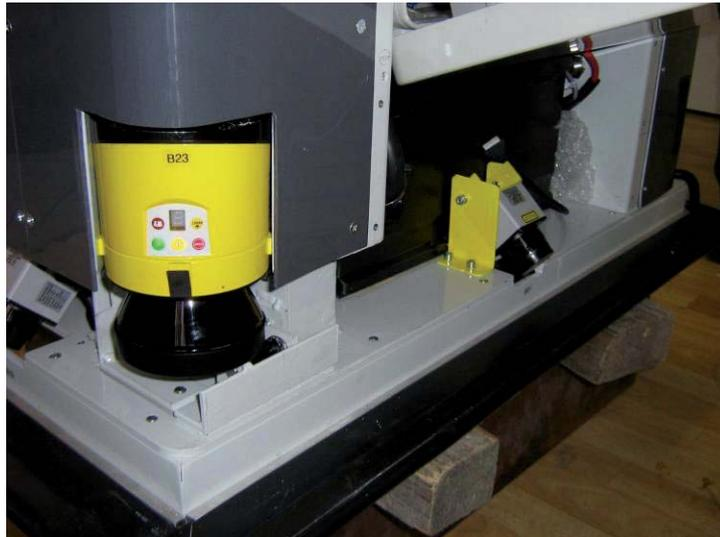
**Abbildung 13: Laserscanner und Schaltleisten**
