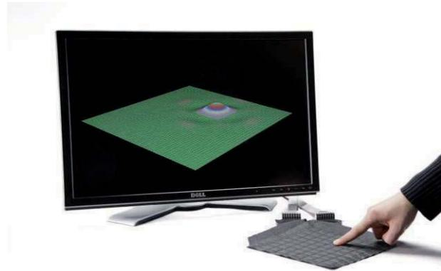
**Abbildung 27: Prototyp der taktilen Haut mit Messwertvisualisierung**
