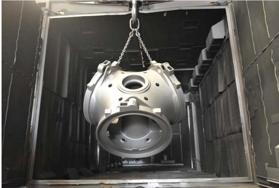
**Bild 1 Rotornabe einer Windenergieanlage /Mik14/**
