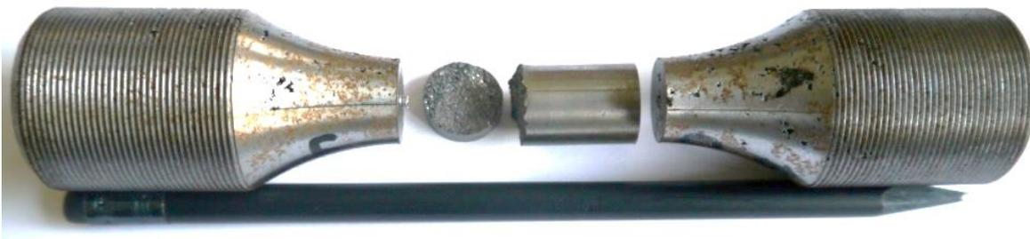
**Bild 77 Schwingprobe mit herausgetrenntem Prüfvolumen für Wägung**
