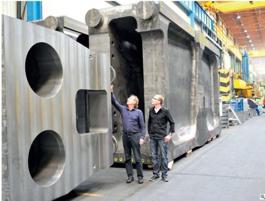
**Bild 2 Gussbauteile einer Großpresse /Fas14/**
