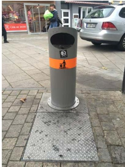
In Reutlingen wurden 15 Unterflur-Container in der Fußgängerzone mit Füllstandssensoren ausgestattet. Zwei unterschiedliche Zustände sollen dabei erkannt werden, die ein Eingreifen verlangen: Mülleimer ist voll bzw. Mülleimer ist (nicht voll aber) verstopft – beispielsweise durch einen sperrigen Karton. Zu diesem Zweck werden pro Müllbehälter zwei Sensoren verbaut.
