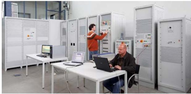
**Bild 6: ISET *MPP-Meter* (Kennlinienmessung von Solarmodulen (links), PV-Simulator zur Wechselrichterprüfung (rechts))**
