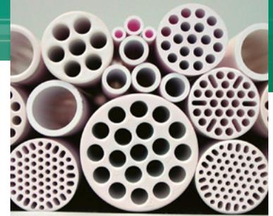
Keramik-Membranen des Fraunhofer IKTS. © Fraunhofer IKTS
