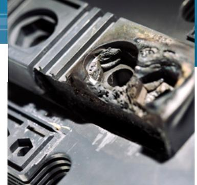
Wenn das Schutzgehäuse Schaden nimmt, kann das gesamte elektronische Bauteil ausfallen. Darum sollen Materialrezepturen und Verarbeitungstechniken der Gehäuse optimiert werden.
