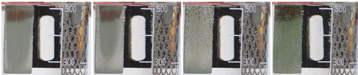
**Abbildung 2.11: Transpassiver Elektropoliturvorgang eines Edelstahlsubstrates (1.4404) bei  $50 \text{ mA cm}^{-2}$  in einer Methansulfonsäure/ 1,2-Propandiol Elektrolytlösung Verhältnis (1:1) mit von links nach rechts steigender Polierdauer 10 s, 20 s, 40 s und 180 s<sup>230</sup>.**
