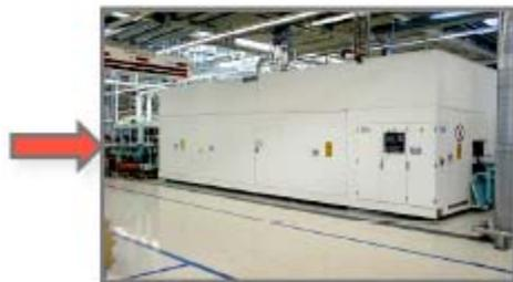
Reinigungsanlage mit Hochdruck (600 bar)
