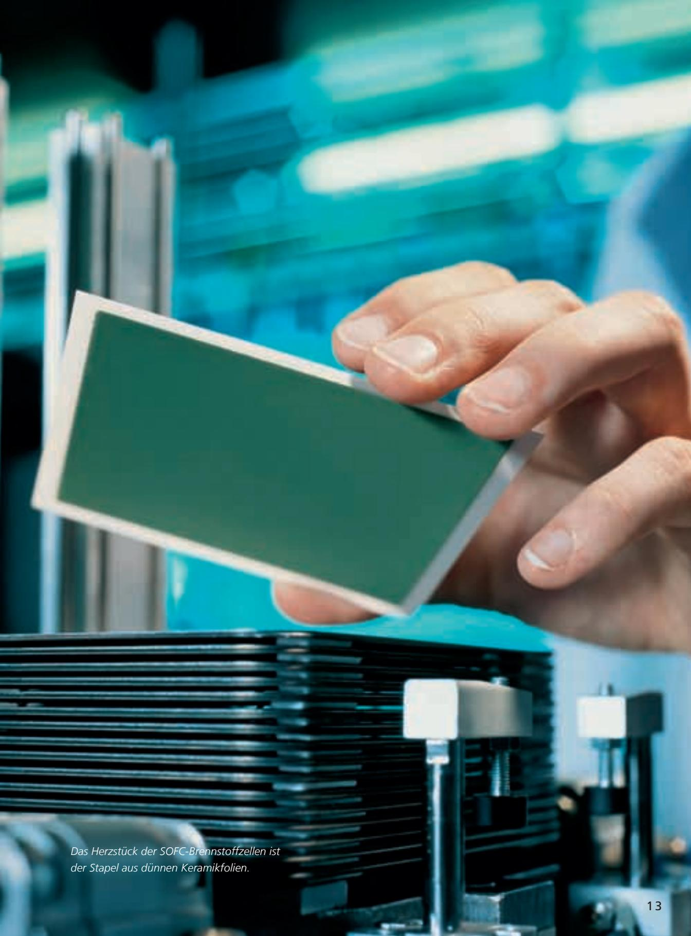
*Das Herzstück der SOFC-Brennstoffzellen ist der Stapel aus dünnen Keramikfolien.*
