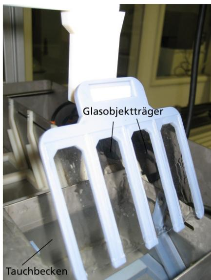
*Abbildung 4.9 Tauchbeschichtung von Glasobjektträgern in einem Magazin*
