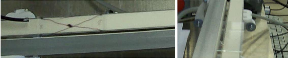
*Abbildung 6.16 90°-Verfahren mit Vorschub des Werkstückes durch Luftdüse*
