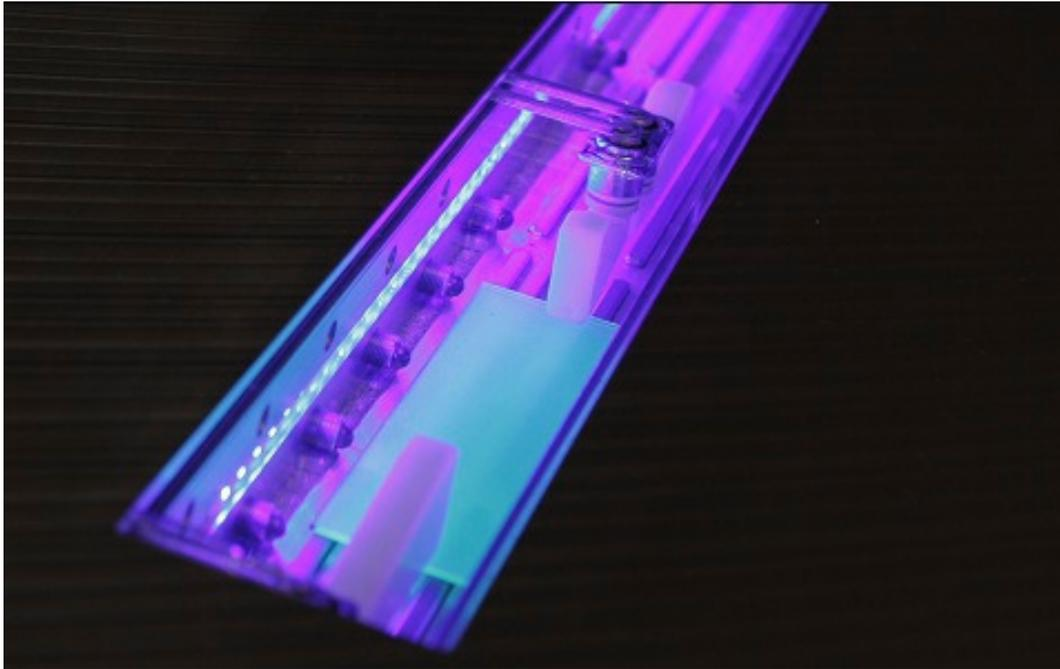
*Abbildung 7.5 Ein Glasobjektträger wird im Transportsystem berührungslos positioniert*
