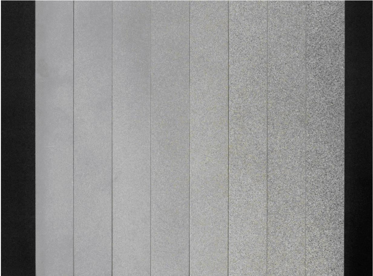
*Abbildung 5.9 Sintermaterial nach Feinheitsgrad - von 2  $\mu\text{m}$  (links) bis 120  $\mu\text{m}$  (rechts)*
