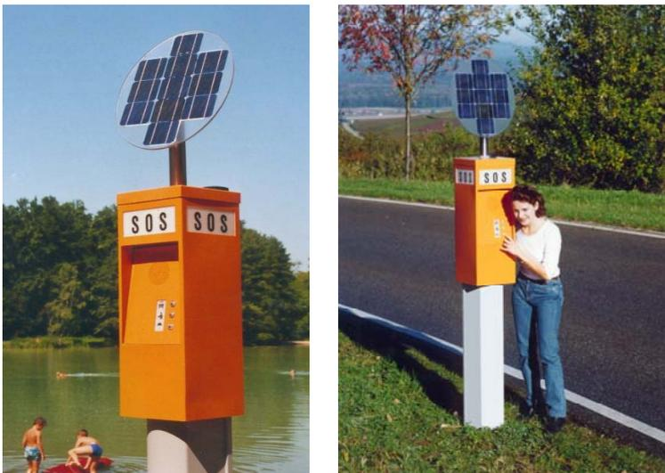
Abb. 2: Prototypen des multifunktionalen Notruf- und Informationssystems mit photovoltaischer Stromversorgung (Fa. abac).
