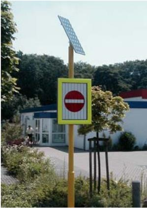
Abb. 3: Photovoltaisch versorgter Prismenwender (Fa. via traffic controlling gmbh).
