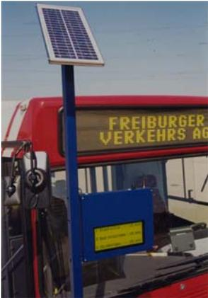
Abb. 1: Photovoltaisch versorgtes Fahrgast-Informationssystem (Fa. AEG MIS).
