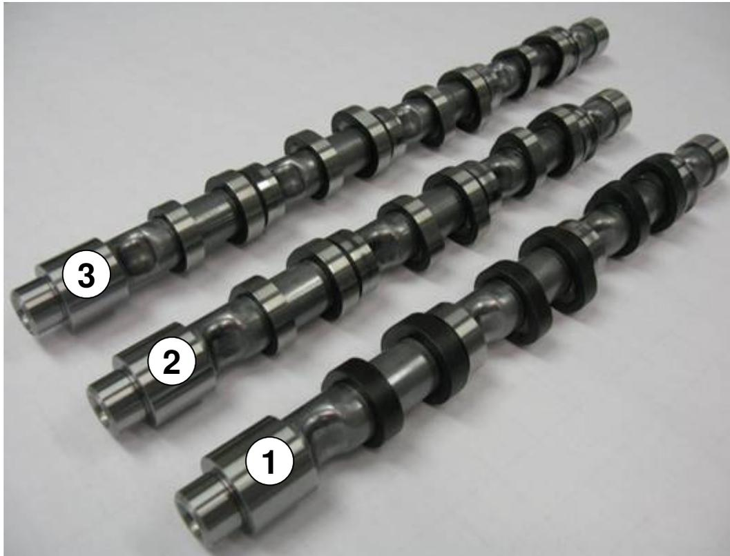
Auslass-Nockenwellen Dieselmotor Common-Rail:
