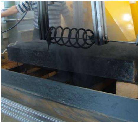
Abb. 67: Kombination einer Linearbewegung mit einer Drehbewegung zur Pulverbeschichtung von Schraubenfedern
