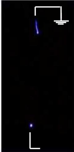
Abb. 75: aktive Punktelektrode (unten) und passive, geerdete Spitze mit sichtbarer Gegenkorona
