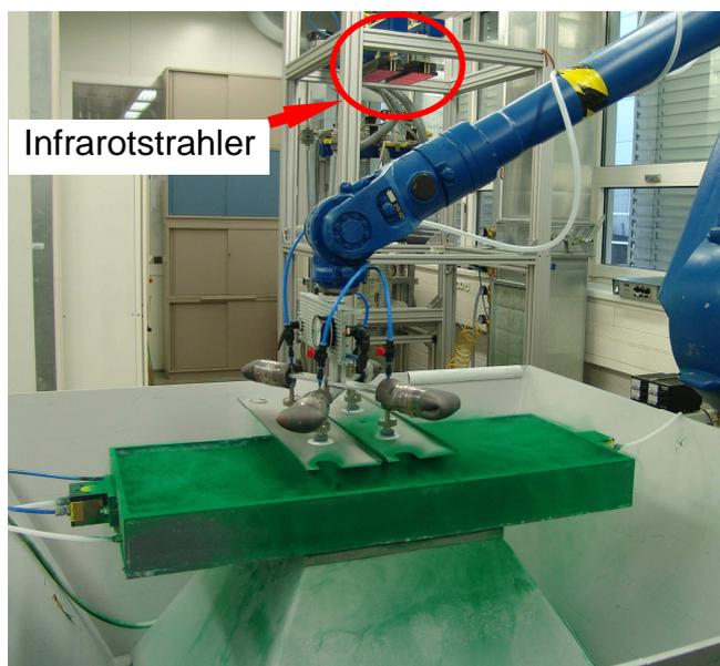
Abb. 4: modulares Beschichtungskonzept mit Vorwärmzone, Applikationsbereich und Infrarot-Aufschmelz- bzw. Vernetzungszone (gemeinsam mit Fa. Hege)
