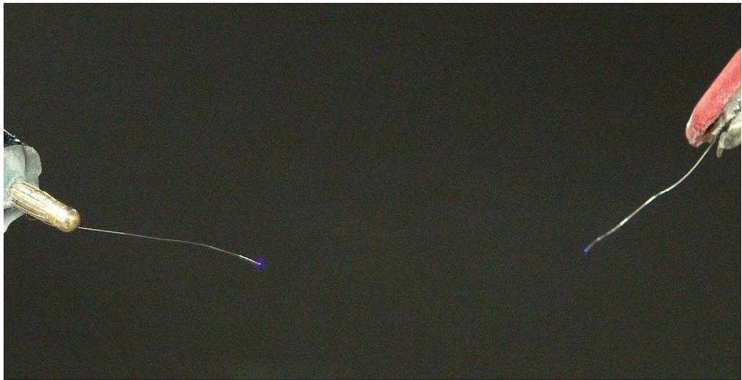
Abb. 34: Koronaelektrode, blau leuchtend (links) und geerdeter, dünner Draht mit (blau leuchtender) Gegenkorona (rechts)
