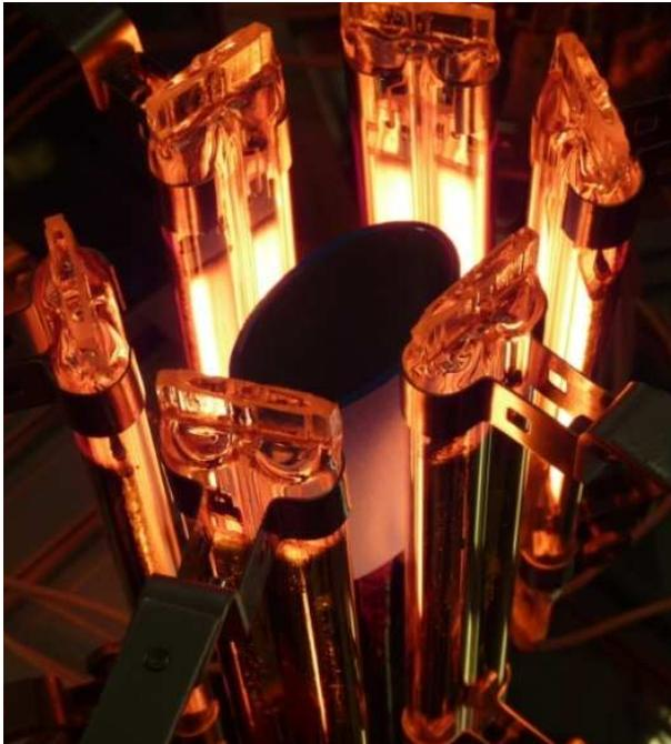
Abb. 81: 6 wabenförmig ums Werkstück angeordnete Carbon-Strahler
