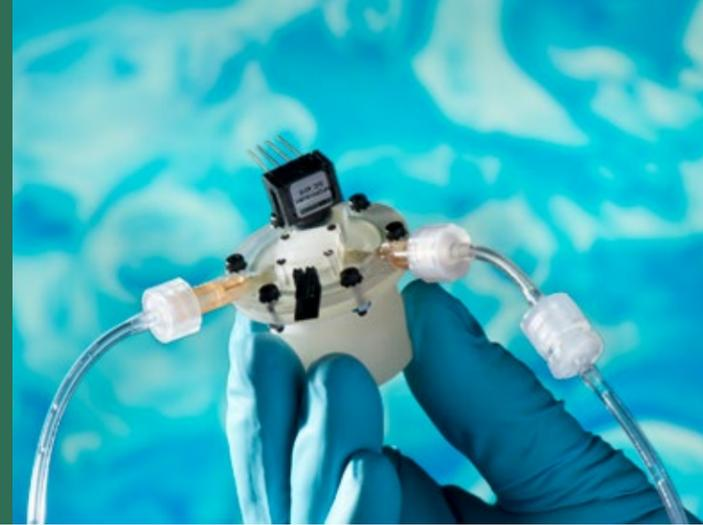
Entgaser basierend auf Mikropumpe
