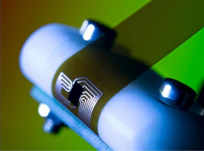
Zuverlässigkeitsprüfung von dünnen Chip-Folienpackages
