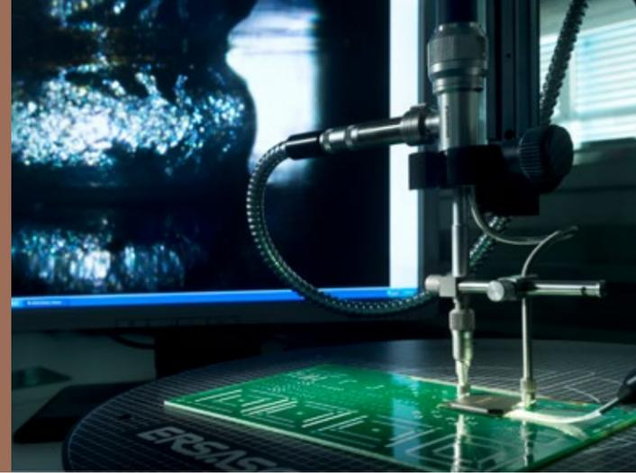
Kontrolle verdeckter Lötverbindungen (BGA, PGA, QFN)
