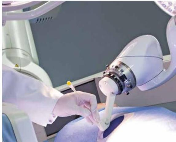
Abbildung 5: Positionierung der Biopsienadel durch den Roboterarm
